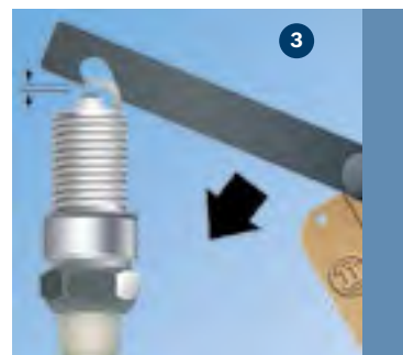
3 Si es necesario, aumentar la distancia entre los electrodos.
