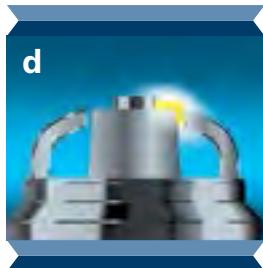
d Electrodo lateral – superficie de aislador – electrodo central
