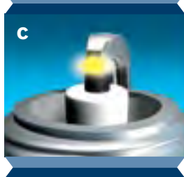
c Electrodo de masa perfilado – electrodo central
