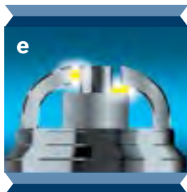
e Electrodo lateral – electrodo central o electrodo lateral – superficie de aislador – electrodo central
